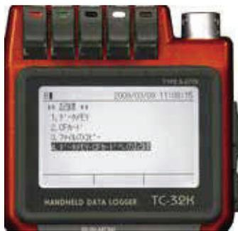
백라이트 부착 액정 표시 해상도 255 × 160 도트 주요 표시 내용 측정 데이터, 설정 리스트, 시계열 데이터의 그래픽 표시 등
