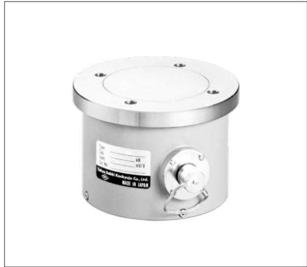
일반용 콘크리트 원기둥 공시체의 강도 시험에 사용하는 하중계입니다. 하중계 상부면에 원기둥 공시체를 그대로 얻을 수 있습니다. 또한, 컴프레시미터를 사용해서 하중과 스트레인을 동시에 측정 가능합니다.
