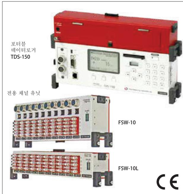
TDS-150은 전용 채널 유닛 (FSW-10/FSW-10L)과 조합하여 스트레인게이지, 스트레인게이지식 변환기, 직류 전압, 열전대, 백금측온저항체를 측정할 수 있는 포터블 데이터로거입니다. 10채널 유닛 (FSW-10/FSW-10L)은 최대 5대 (50채널)까지 접속할 수 있습니다. 또한 스위칭박스 TML-NET 구동 보드 (옵션)로 최대 100채널까지 접속할 수 있습니다. AC전원을 사용할 수 없는 장소에서도 시판의 알칼리 건전지나 배터리로 동작할 수 있고 장기에 걸쳐 자동 측정이 가능한 데이터 메모리와 슬립 인터벌 타이머 기능을 탑재하고 있습니다.
