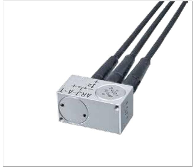
기계, 차량, 선박, 토목·건축 등의 분야에서 가속도 측정용으로 개발된 가속도계입니다. 소형, 경량, 고응답으로 설계되었습니다. ARJ-A 시리즈의 3축(3방향) 측정용이지만, 높이는 2축용과 같은 14mm입니다. 질량은 2축용의 약2배 정도로 경량입니다.
