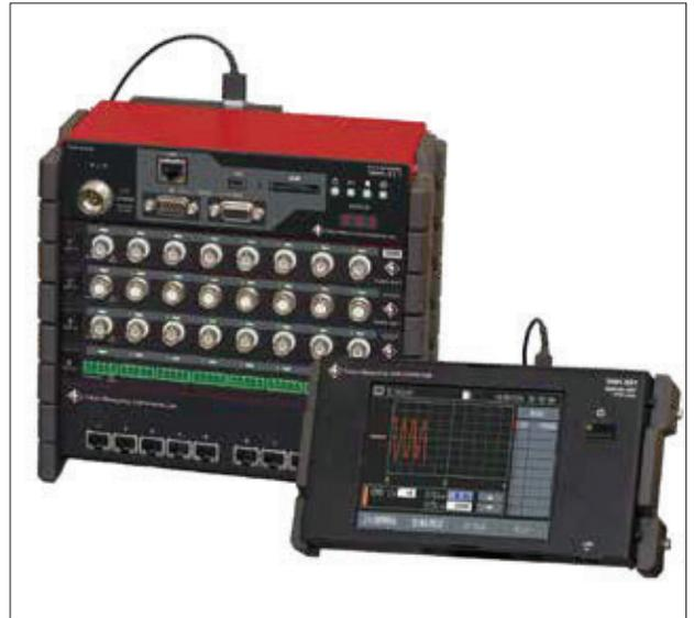
멀티 레코더 TMR-300 시리즈는 목적에 따라 각종 센서 입력용 측정 유닛을 간단하게 조합할 수 있는 소형 다채널 데이터 수록 시스템입니다. 소형·경량이므로 설치 공간에 제한이 있는 시설 구조물(설비 기계, 교량 등)뿐만 아니라 자동차, 항공기, 선박 등의 이동체에도 설치 및 측정이 간단합니다. 각종 센서의 입력이 되는 측정 유닛은 스트레인계이지나 직류 전압, 열전대 등에 대응하여 최대 80점의 측정이 가능합니다. 파형 기록뿐만 아니라 실시간 빈도 해석 처리(옵션)가 가능합니다.
